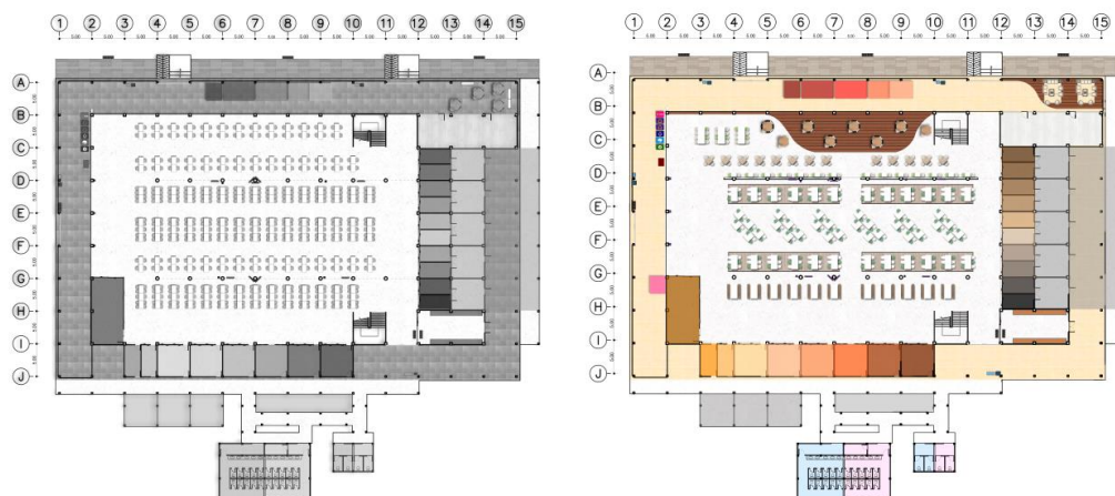
ภาพที่ 9 ผังพื้นที่ชั้น 1 ก่อนและหลังการปรับปรุง
