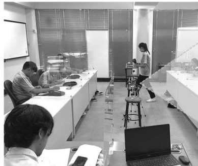
ภาพที่ 2 ตำแหน่งเครื่องมือวัดภายในห้องทดลอง (1) กล้องความร้อน (2) เครื่องมือวัดอุณหภูมิ ความชื้น และความเร็วลม
