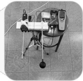
ภาพที่ 2 ตำแหน่งเครื่องมือวัดภายในห้องทดลอง (1) กล้องความร้อน (2) เครื่องมือวัดอุณหภูมิ ความชื้น และความเร็วลม
