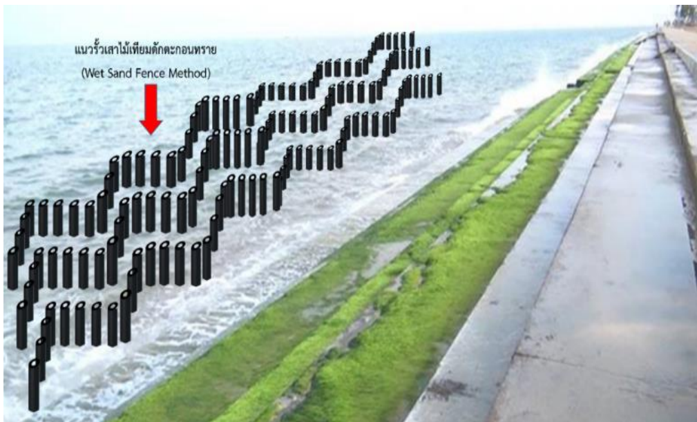
ภาพที่ 16 แสดงแนวความคิดการใช้เส้าไม้เทียมดักตะกอนทรายด้านหน้าบันไดกันคลื่น ที่มา: วิเชียร พุทธศรี ผู้เขียน
