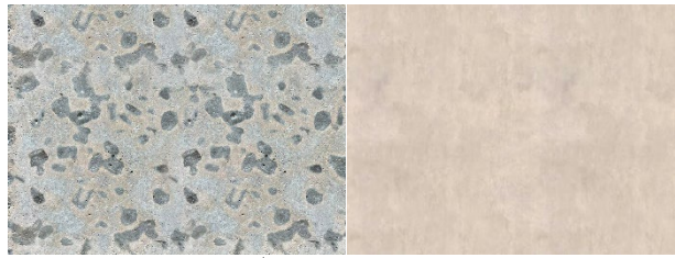
ภาพที่ 16 ภาพสามมิติผิวแผ่นคอนกรีตสำเร็จรูปที่มีส่วนผสมจากผักตบชวาและภาพฉาบผิวบางในมุมมองด้านหน้าตรง
