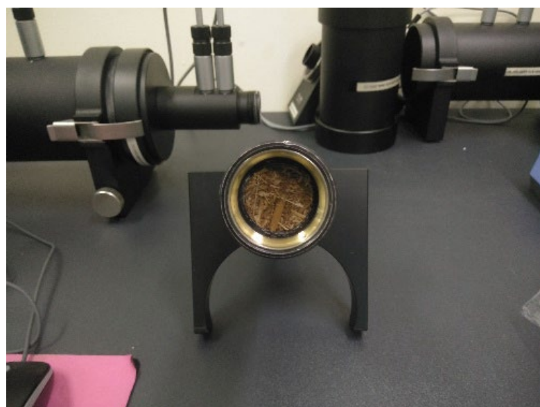
ภาพที่ 8 การทดสอบด้านการดูดซับเสียง แผ่นชิ้นงานที่ทดสอบ เส้นผ่าศูนย์กลาง 3 เซนติเมตร หนา 1 เซนติเมตร
