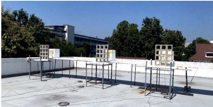
ภาพที่ 8 กล่องทดลองการทดสอบครั้งที่ 3.2 การใช้บล็อกช่องลมที่มีค่า OBR 46.81 % เป็นผนังชั้นที่สองให้แก่กล่องทดสอบที่มีผนังจำลองทั้ง 3 ประเภท
