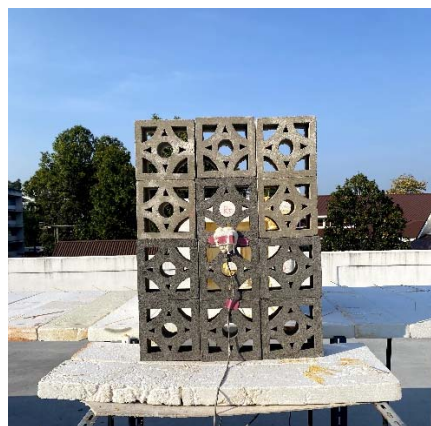
ภาพที่ 9 การทดสอบครั้งที่ 3.3 ที่ทำการทดสอบเหมือนกับการทดสอบครั้งที่ 3.2 โดยเปลี่ยนบล็อกช่องลมเป็นบล็อกที่มีค่า OBR 22.11 % เป็นผนังชั้นที่สองให้แก่กล่องทดสอบที่มีผนังจำลองทั้ง 3 ประเภท
