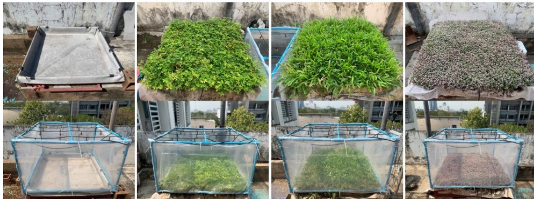
ชุดทดลองที่ 1 กระบะทดลองหลังคาคอนกรีต ชุดทดลองที่ 2 กระบะทดลองหลังคาเขียว พืช C3 (ถั่วบราซิล) ชุดทดลองที่ 3 กระบะทดลองหลังคาเขียว พืช C4 (หมูมาเลเซีย) ชุดทดลองที่ 4 กระบะทดลองหลังคาเขียว พืช CAM (ฝรั่งบ้านชาลี)
