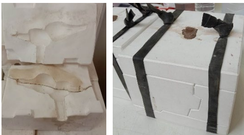
ภาพที่ 17 แม่พิมพ์ใช้ในการหล่อน้ำดิน
