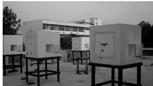
ภาพที่ 3 เซลล์ทดสอบทั้ง 6 เซลล์ที่มีการติดตั้งผนังทดสอบ และมีการติดตั้งหัววัดอุณหภูมิในตำแหน่งต่าง ๆ
