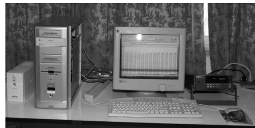
ภาพที่ 4 อุปกรณ์ที่ใช้ในการเก็บข้อมูลได้แก่เครื่องประมวลผล Fluke Hydra Logger พร้อมกับหัววัดและสายวัดอุณหภูมิ
