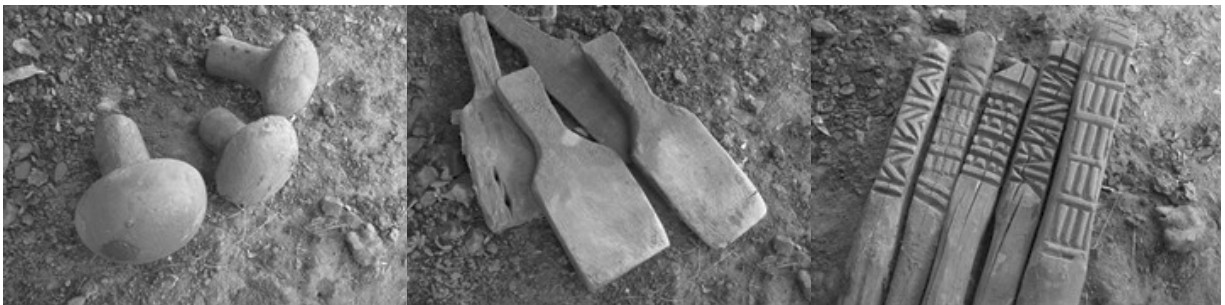
ภาพที่ 2 เครื่องมือในการขึ้นรูปหินดูหรือหินตุ๊ด ไม้ตีหลาบหรือไม้ตีราบและไม้ตีลาย
