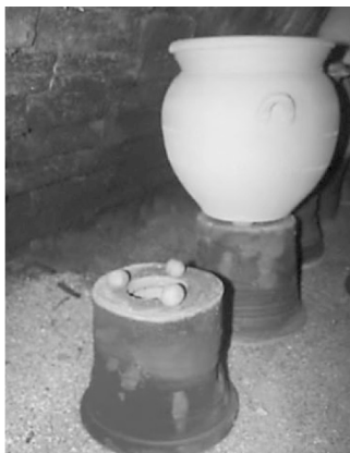
ภาพที่ 10 วิธีการวางชิ้นงานที่เผาเคลือบ
