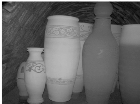
ภาพที่ 11 วิธีการวางชิ้นงานที่เผาเคลือบ
