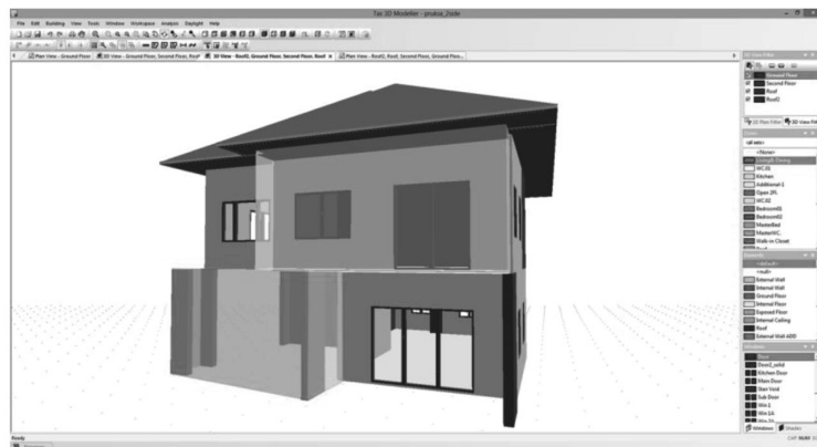
ภาพที่ 4 แสดงรูปแบบบ้านที่ 1 (จอตกร 2 คัน/ โถงบันไดข้างบ้าน) ต่อเติมโรงรถเป็นห้องนอน สร้างเป็นโมเดล 3 มิติด้วยโปรแกรม Tas EDSL
