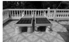
ภาพที่ 13 การทดสอบแผงตั้งมุมบานเกล็ด 16° และ 90 กับแผงนอนมุมบานเกล็ด 16° และ 0°
