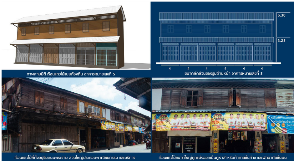
ภาพที่ 10 อาคารเรือนแถวไม้ขนาดความลึก 6 - 8 เมตร ความสูง ราว 6.5 เมตร (2 ชั้น) ขนาดหน้ากว้างของคูลา 4 เมตร เป็นรูปแบบมาตรฐานที่พบในพื้นที่
