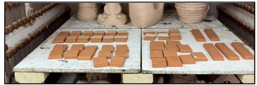
ภาพที่ 8 ภาพแสดงการเผาแผ่นทดสอบสีด้วยเตา ไฟฟ้า ภาพโดย: ผู้วิจัย
