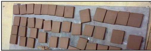
ภาพที่ 6 ภาพแสดงจากเตรียมแผ่นทดสอบจากดิน พื้นบ้านอุบลฯ เพื่อทดลองหาดินสี ภาพโดย: ผู้วิจัย
