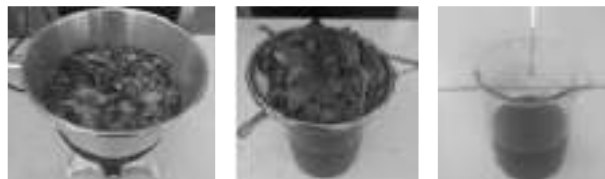
ภาพที่ 2 การสกัดดอกบัวสายสีแดงโดยวิธีการต้ม และการวัดค่า pH
