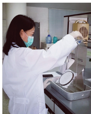
ภาพที่ 2 แสดงการทดสอบการต้านเปียกของผิวผ้าโดยวิธีพ่นน้ำ ที่มา : ธนิกา หุตะกมล, 2563
