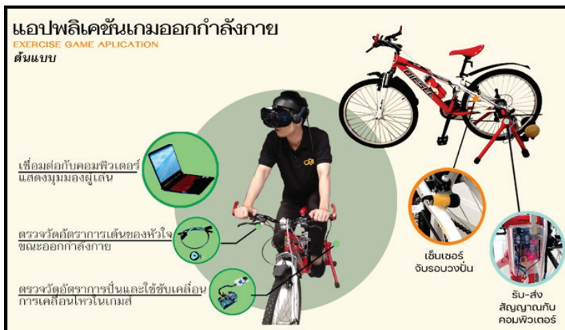
ภาพที่ 3 : ชิ้นงานแอปพลิเคชันเกมออกกำลังกายที่มีลักษณะการเชื่อมต่อประสาน ระหว่างจักรยานและความเป็นจริงเสมือน ที่มา : ผู้วิจัย, 2563
