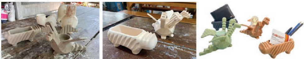
ภาพที่ 8 กระบวนการทำงานเซรามิกตั้งแต่เริ่มต้นหล่อน้ำดิน เผาดิบถึงจบกระบวนการเผาเคลือบ (อรัญ วานิชกร, 2564)
