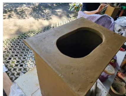
ภาพที่ 20 แสดงการเจาะรูที่ฐานเพื่อระบายอากาศ ที่มา : อภิญา วิไล 2568
