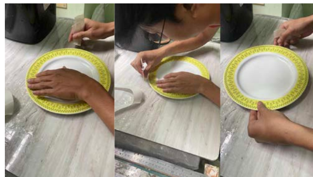
ภาพที่ 11 : การติดDecal ลงบนชิ้นงานเซรามิก (ที่มา : บุญฤทธิ์ ศรีอุไร 2567)
