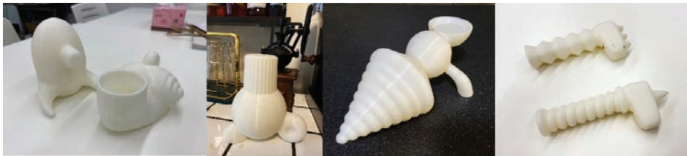
ภาพที่ 6 การพิมพ์ 3 มิติเพื่อเป็นต้นแบบในการสร้างแม่พิมพ์ (อรัญ วานิชกร, 2564)
