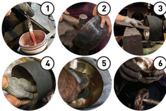
ภาพที่ 1: กระบวนการผลิตชั้นลงหิน (1) การตี, (2) การลาย, (3) การกรอ, (4) การกลึง, (5) การเจียร และ (6) การขัด
