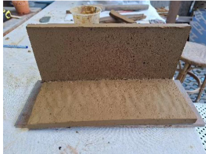
ภาพที่ 16 ทาน้ำดินและวางชั้นส่วน ดินแผ่นเพื่อต่อประกอบ ที่มา : อภิญา วิไล 2568
