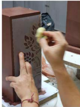
ภาพที่ 25 แสดงการพิมพ์น้ำดินสีขาวผ่านแม่พิมพ์ ที่มา : อภิญา วิไล 2568
