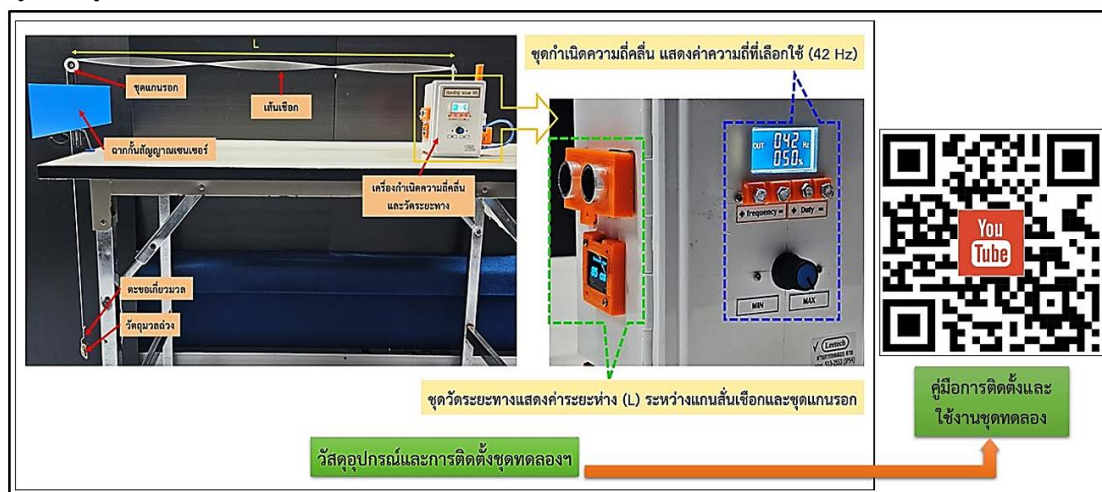
Figure 5 วัสดุอุปกรณ์และการติดตั้งชุดทดลองคลื่นนิ่งในเส้นเชือกแบบพกพาราคาถูก และคู่มือการใช้งาน
