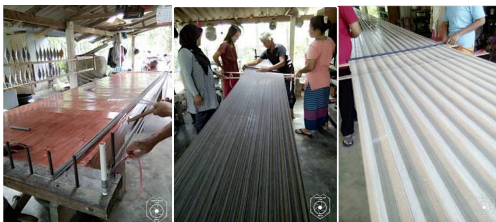
ภาพที่ 6 การเตรียมเส้นด้ายใยสับปะรดปั่น
