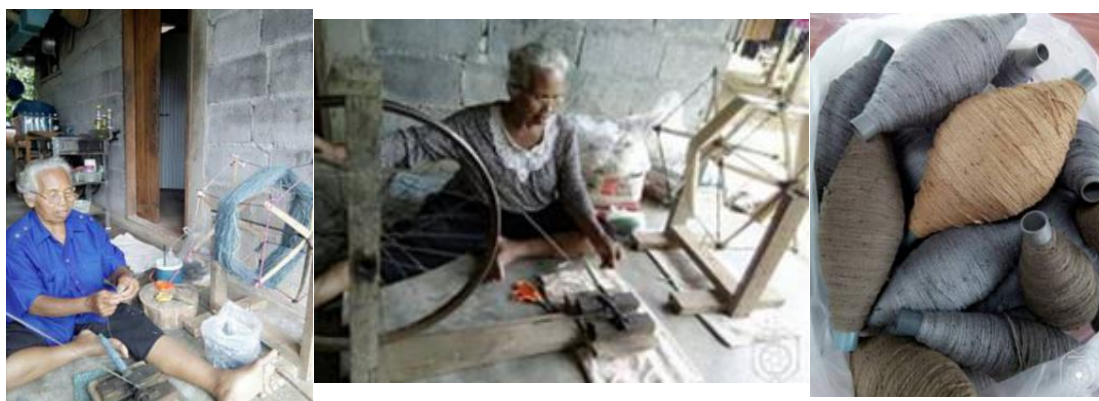
ภาพที่ 5 การกรอเส้นด้ายใยสับปะรดที่ผ่านการย้อมสีธรรมชาติ
