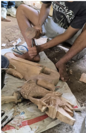
ภาพที่ 1 : ช่างแกะสลักกำลังแกะสลักส่วนฐานของพญานาคจากไม้กระทอน และเครื่องมือแกะสลักที่ตะไบขึ้นมาเอง
