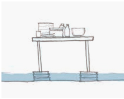
ภาพที่ 9 (ซ้าย) ยกเครื่องเรือนให้สูงกว่าระดับน้ำโดยใช้บล็อกคอนกรีตที่เตรียมไว้ในการทำกำแพงกันน้ำ (กลาง) ใช้ยางรถยนต์รองแผ่นไม้เป็นทางเดินติดต่อระหว่างบ้าน (ขวา) ยกสุขาชั่วคราวให้สูงระดับน้ำท่วมที่คลองบึงไผ่ ที่มา: วาดโดยคณะผู้วิจัย
