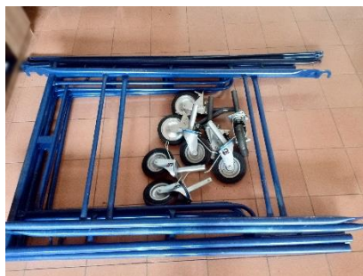
ภาพที่ 14 โครงสร้างนั่งร้าน
