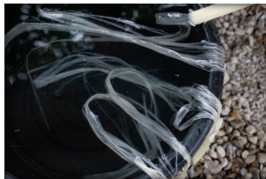
ภาพที่ 3 ภาพเส้นใยกล้วยที่ผ่านเครื่องแยกเส้นใย
