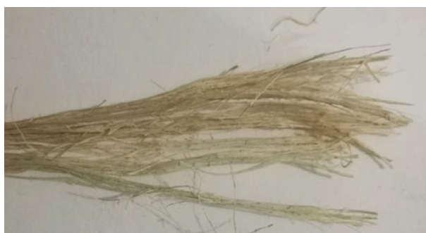
ภาพที่ 2 เส้นใยที่ผ่านกระบวนการเชิงกลขั้นต้นเพื่อแยกกลืนออกจากเซลล์ลูโลสโดยการทุบ
