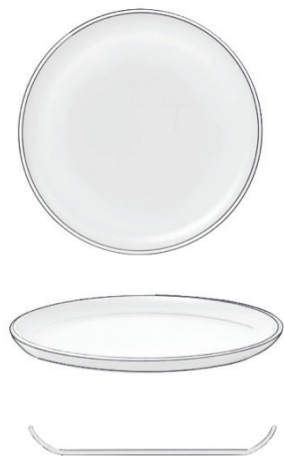
ภาพที่ 6 รูปทรงของจานในรูปด้านบน ด้านข้าง และรูปหน้าตัด
