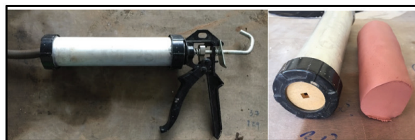
ภาพที่ 11 ดัดแปลงเครื่องอัดรีดดินจากปิ่นยิงซิลิโคน
