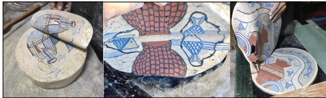
ภาพที่ 17 การตัดแผ่นขึ้นส่วนเพื่อไปขึ้นรูปด้วยแม่พิมพ์แบบอัด
