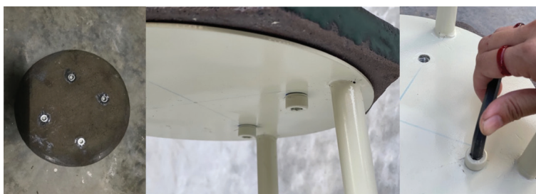
ภาพที่ 15 ภาพการประกอบน็อต ได้ออกแบบให้แผ่นรองเก้าอี้นั้นสามารถเปลี่ยนถอดขึ้นแผ่นรองได้
