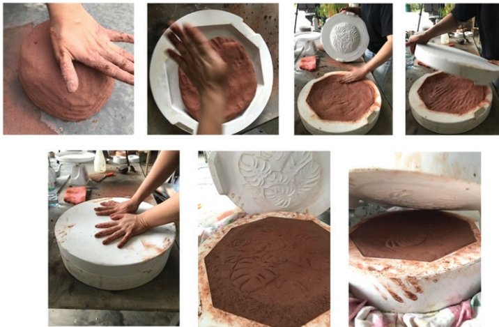
ภาพที่ 10 ขั้นตอนการอัดดิน เพื่อผลิตชิ้นงาน
