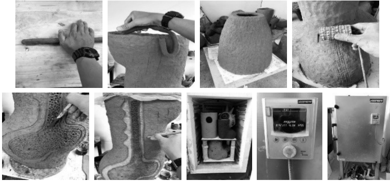
ภาพที่ 7 การขึ้นรูปชิ้นงานด้วยมืออิสระ (Hand Forming) การตกแต่งกตพิมพ์ลายและการเขียนสีออกไซด์และการเผาด้วยเตาไฟฟ้าอุณหภูมิที่ 1,200 องศาเซลเซียส (72-96 ชั่วโมง) (ดุริวัฒน์ ตาโธสง, ประเทศไทย, 2564)
