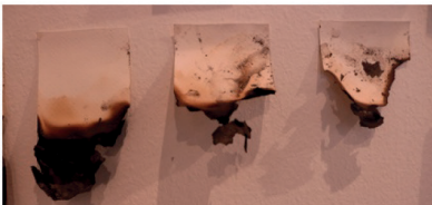
ภาพที่ 5 ภาพแสดงรายละเอียด อันเกิดจากร่องรอยของการเผาไหม้ คราบเขม่าไฟ คราบน้ำมันบนวัสดุรองรับ (วสวัตดี ธิยาพนธ์, ประเทศไทย, 2566)
