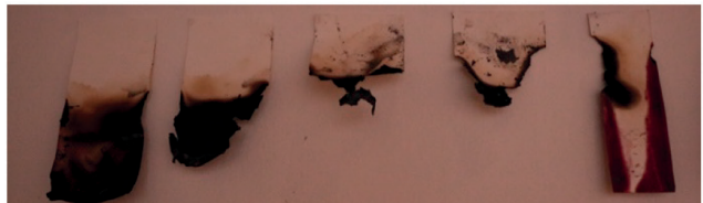
ภาพที่ 5 ภาพแสดงรายละเอียด อันเกิดจากร่องรอยของการเผาไหม้ คราบเขม่าไฟ คราบน้ำมันบนวัสดุรองรับ (วสวัตดี ธิยาพนธ์, ประเทศไทย, 2566)
