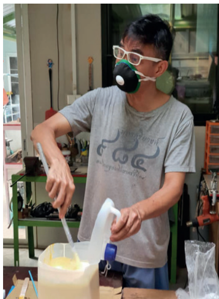
ภาพที่ 2 กระบวนการผสมเรซิน วัสดุหลักในการทำซอด้วงจากวัสดุทดแทนของครูจักรี มงคล
