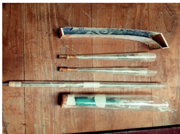
ภาพที่ 3 แม่พิมพ์สำหรับการหล่อเรซินเป็นรูปทรงต่าง ๆ สำหรับใช้กลึงเป็นชอด้วง
