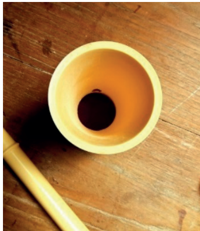
ภาพที่ 1 การกลึงโพรงกระบอกซอด้างจากวัสดุทดแทน(เรซิน)ของครูจักรี มงคล
