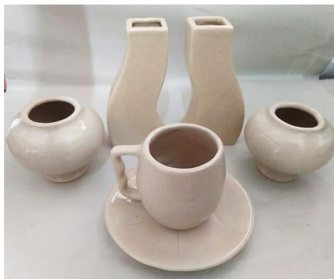
รูปที่ 6 เคลือบซีเถ้าไม้ยางพาราเผา 1250 °C ในบรรยากาศออกซิเดชั่น (OF)
